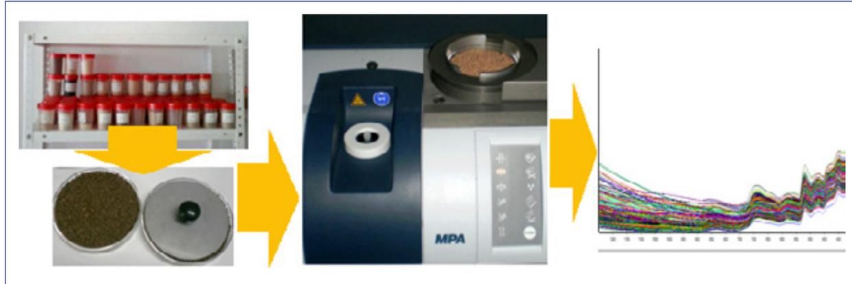
**Figura 1.** Proceso de análisis NIR de una muestra de hueso de aceituna de almazara. Colocación de la muestra en placa Petri, análisis NIR en reflectancia (segundos) y obtención de espectros de biomasa.
